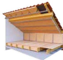
COMBLES AMÉNAGÉS SOUS-RAMPANT
