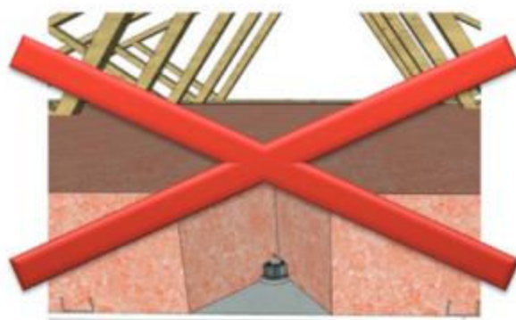
Figure 4 – Spot non protégé au contact de l'isolant interdit
